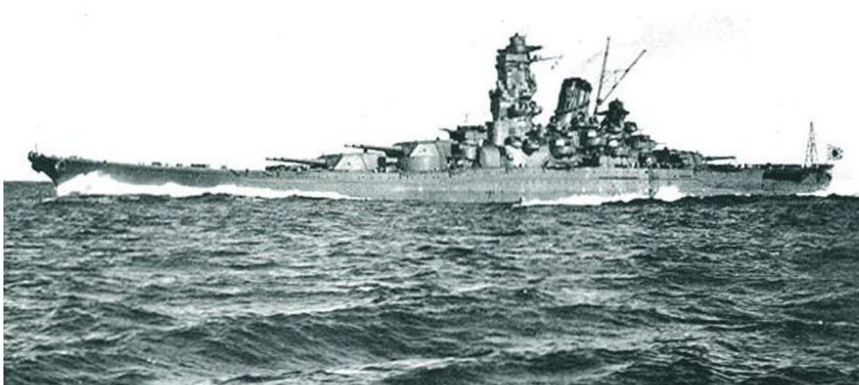
Супердредноут «Ямато». Длина – 263 м. Экипаж – 3332 матроса и офицера. Вес снаряда – 1500 кг, дальность выстрела – 42 км
